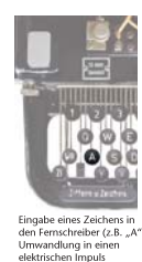
Eingabe eines Zeichens in den Fernschreiber (z.B. „A“), Umwandlung in einen elektrischen Impuls
